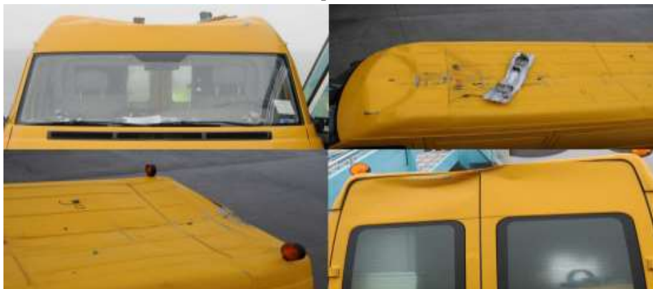
Slika 2. Oštećenje aerodromskog vozila uzrokovano kontaktom sa zrakoplovom
